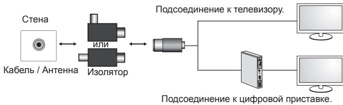
Подсоедините окончание изолятора к розетке кабеля/антенны, а другой его конец к телевизору или цифровой приставке.
