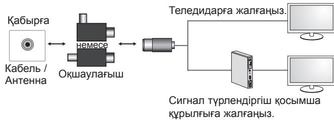
Оқшаулағыштың бір үшін кабель/антенна үясінә, ал екінші үшін теледидарға немесе сигнал түрлендіргіш қосымша құрылғыға жалғаңыз.
