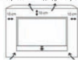
Не допускать попадания внутрь устройства металлических предметов, игл, скрепок, жидкостей, парафина и т.п. через вентиляционные отверстия на задней панели телевизора. Подобные предметы могут привести к короткому замыканию, а также возгоранию телевизора.
