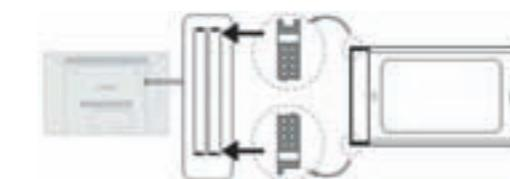
Аккуратно вставить CA-модуль в один из CI-разъёмов, стороной контактов вперёд. Не использовать силу при установке. Убедиться в том, что модуль вошёл прямо, а не под углом, продвинуть CA-модуль как можно дальше.
