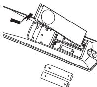
Снимите заднюю крышку, открываяющую доступ к батарейному отсеку, и вставьте батарейки, соблюдая полярность. Для данного пульта дистанционного управления подходят батарейки типа АА, IEC R6 1,5 В.
