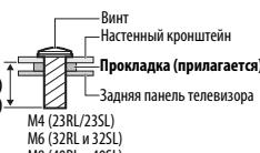
**ВНИМАНИЕ:** Диаметр и длина винтов отличаются в зависимости от модели стенного кронштейна. Использование каких-либо других винтов, отличающихся от указанных винтов, может привести к неисправности внутренних устройств телевизора или к его падению и т.п.
