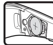
**4** Вставьте новую плоскую батарею в металлический фиксатор и опустите её в отсек.
