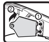
**6** Закрутите винт, удерживающий крышку батарейного отсека.
