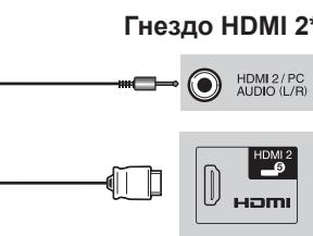
\* В случае использования гнезда HDMI 2 необходимо выбрать нужную опцию в меню «Выбор аудио» в зависимости от типа подключенного кабеля HDMI (Для получения подробной информации см. стр. 43).
