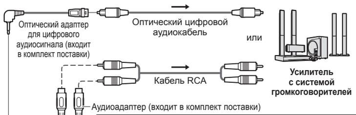
Для прослушивания многоканального звучания с внешнего оборудования (например, Dolby Digital 5.1 кан) подключите оборудование к усилителю. Относительно подсоединения прочитайте инструкции по эксплуатации оборудования и усилителя.
